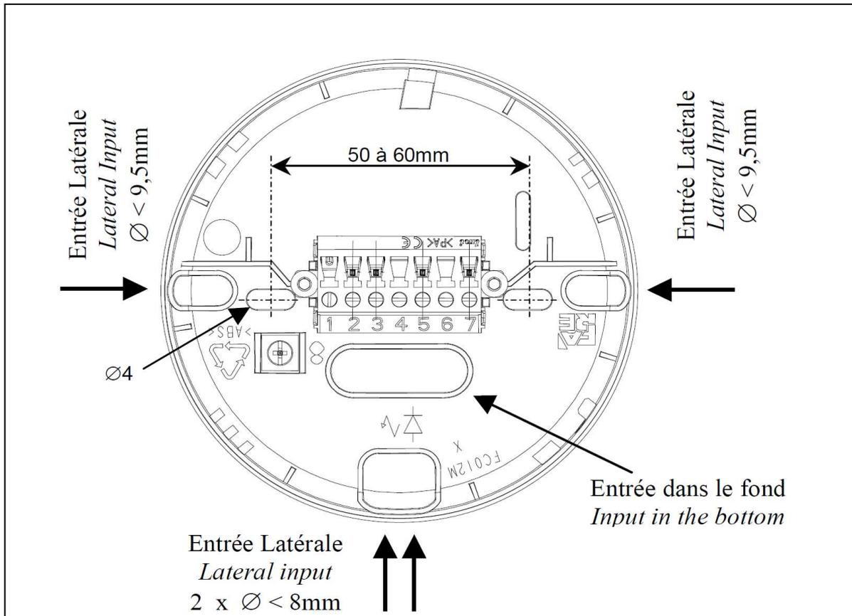
Raccordement et installation du socle S05EX
