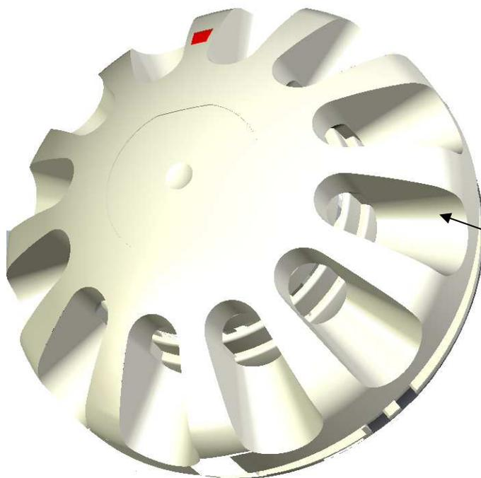
Emplacement de l'aimant pour simuler une alarme ou un dérangement
