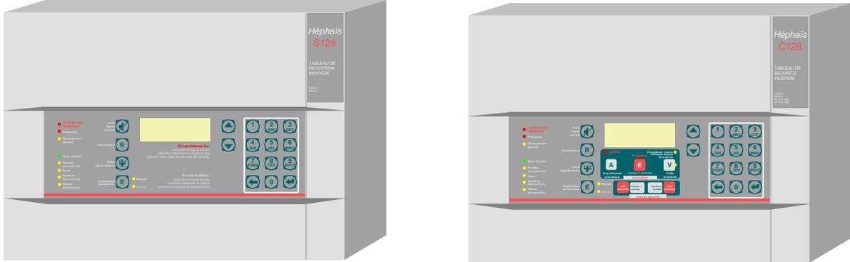
Héphaïs S128 et Héphaïs C128 sont des équipements de contrôle et de signalisation (ECS) dont la variante C est dotée d'un centralisateur de mise en sécurité incendie (CMSI) regroupant une unité de gestion d'alarme de type 1 (UGA.1) et un ensemble de 2 fonctions de mise en sécurité incendie.
