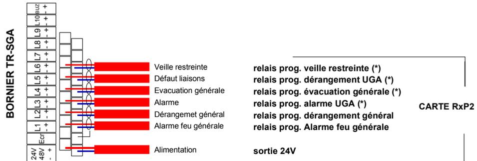
La ligne d'alimentation est réalisée soit en câble 1 paire 8/10 CR1, soit en câble 2x1,5<sup>2</sup> CR1.
