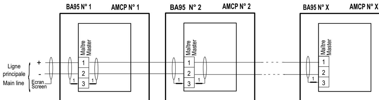
DMA95 ou DMA05F avec isolateur
