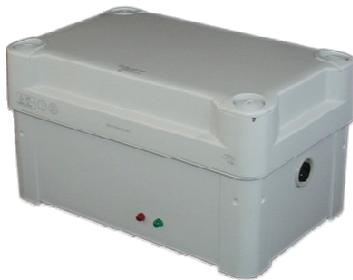
L'OI-BT05W, organe intermédiaire permettant de faire les tests de portés et de canaux. Il communique avec le DM-BT05W par liaison radio. Il communique avec le DETTEL par l'intermédiaire du câble fourni.
