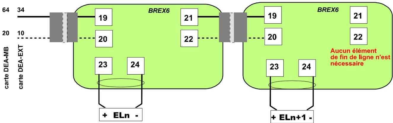
***ligne des dispositifs d'ouverture des vannes équipée d'électrovannes "EL"***
