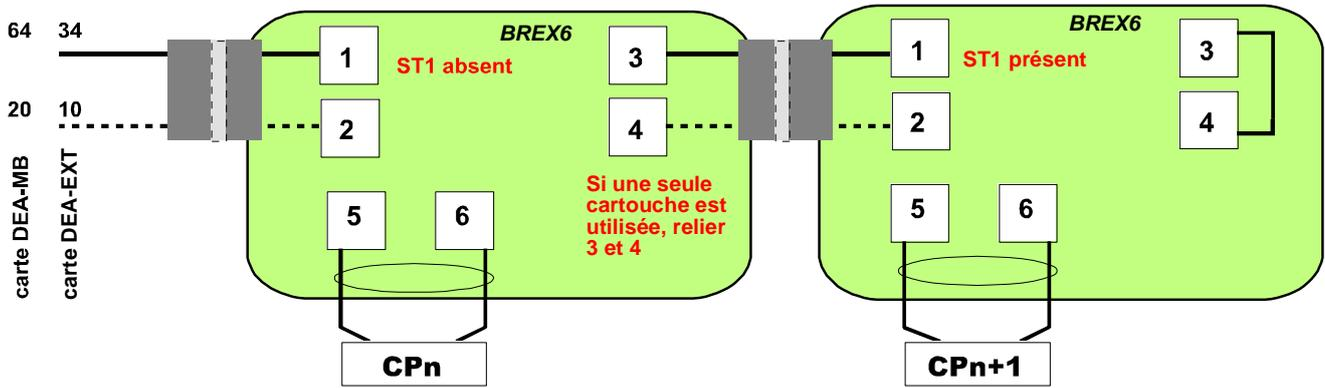
***ligne des dispositifs d'ouverture des vannes équipée de cartouches pyrotechniques "CP"***
