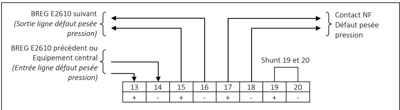
Afin d'assurer la surveillance de la ligne, il est impératif de raccorder un élément de fin de ligne sur le dernier boîtier BREG E2610 raccordé. La valeur de l'élément de fin de ligne est déterminée dans la documentation de l'équipement central. Le raccordement s'effectue de la manière suivante :
