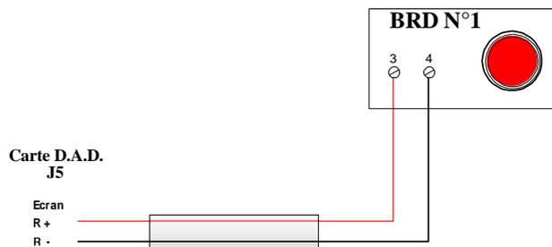
Principe de raccordement des organes asservis.
